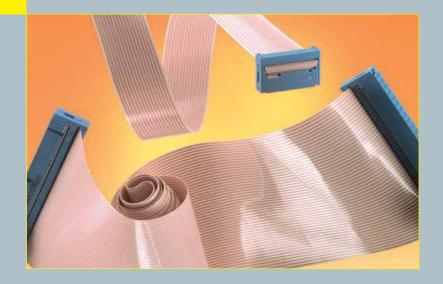
Rasterstegleitungen werden von uns vorgestanzt, abgelängt, vercrimpt und in Schneidklemmtechnik verarbeitet.
